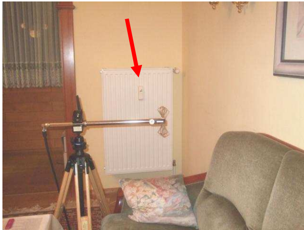
Messantenne vor Techem-Sender
